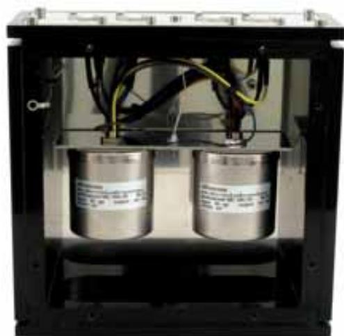
In bella vista i due trasformatori di interfacciamento, accuratamente schermati; come è possibile rilevare dalle indicazioni riportate sui loro involucri, il costruttore ha opportunamente previsto anche gli schermi tra primario e secondario.
