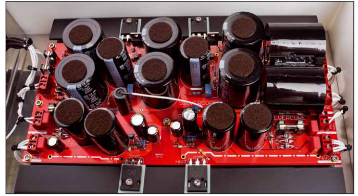
Die Netzteil-Sektion mit sorgfältig bedämpften Kondensatoren
