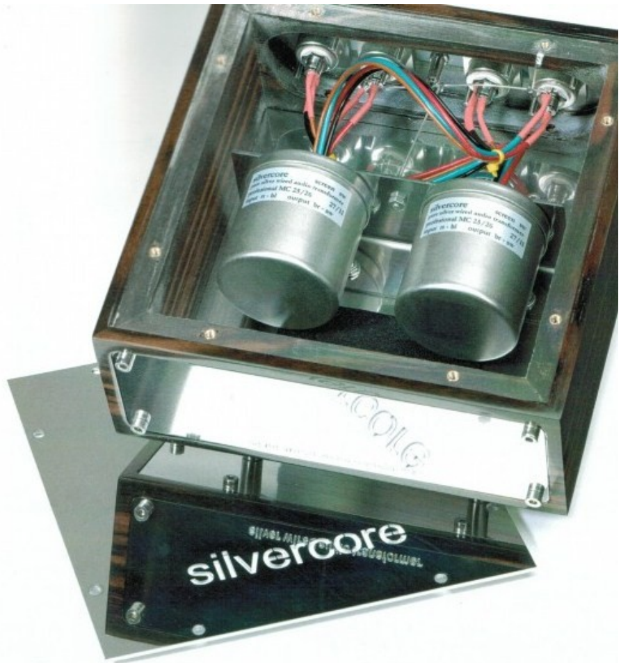
Der Silvercore MC Pro im Ebony-Gehäuse. Beide Übertrager sind in Mu-Metall komplett verkapselt. Dennoch lautet die Devise: Nicht in die Nähe von Netztrafos!
